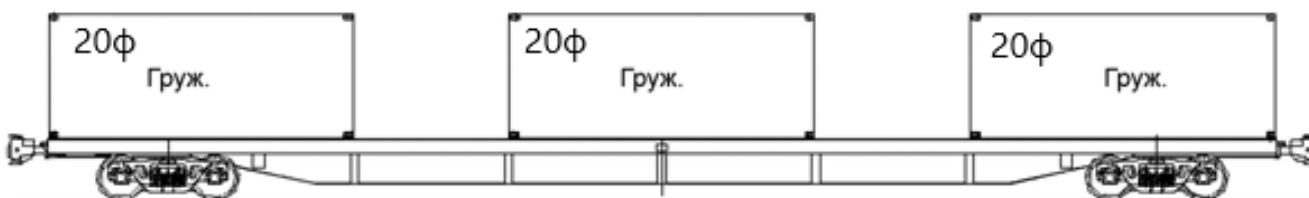
Рисунок 6 - Схема размещения на платформе трех грузеных 20 футовых контейнеров
