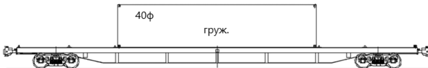
Рисунок 2 - Схема размещения на платформе одного груженого 40 футового контейнера
