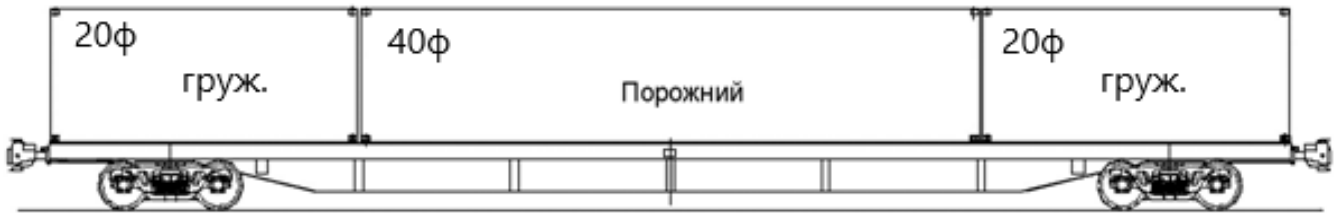
Рисунок 10 - Схема размещения на платформе одного порожнего 40 футового контейнера и двух грузеных 20 футовых контейнеров
