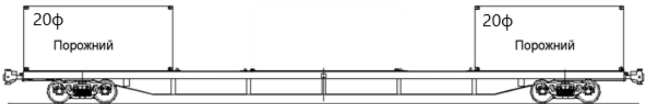
Рисунок 15 - Схема размещения на платформе двух порожних 20 футовых контейнеров
