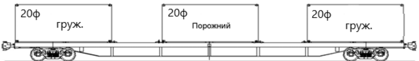
Рисунок 11 - Схема размещения на платформе одного порожнего 20 футового контейнера и двух грузеных 20 футовых контейнеров
