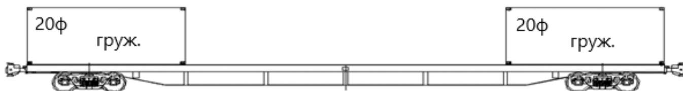
Рисунок 4 - Схема размещения на платформе двух грузенных 20 футовых контейнеров
