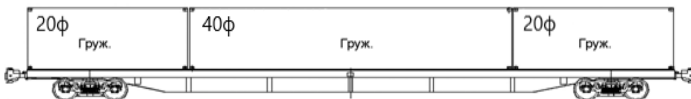
Рисунок 8- Схема размещения на платформе одного грузеного 40 футового контейнера и двух грузенных 20 футовых контейнеров
