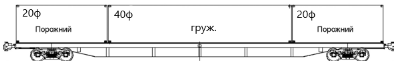
Рисунок 12 - Схема размещения на платформе одного грузенного 40 футового контейнера и двух порожних 20 футовых контейнеров
