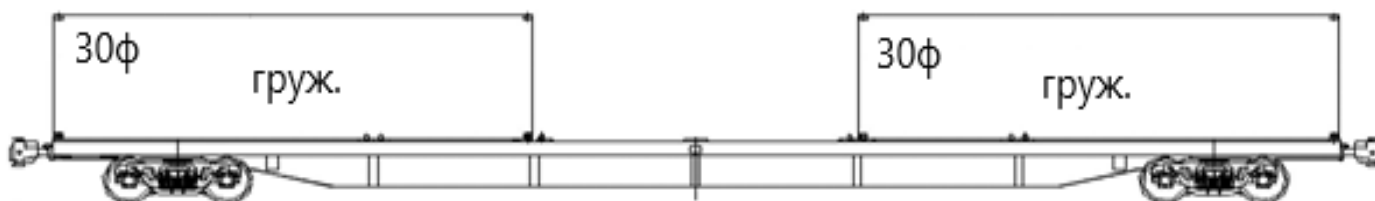
Рисунок 7 - Схема размещения на платформе двух грузенных 30 футовых контейнеров
