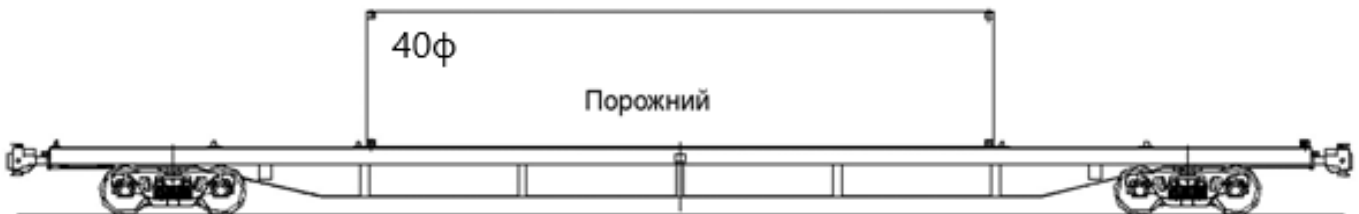
Рисунок 18 - Схема размещения на платформе одного порожнего 40 футового контейнера
