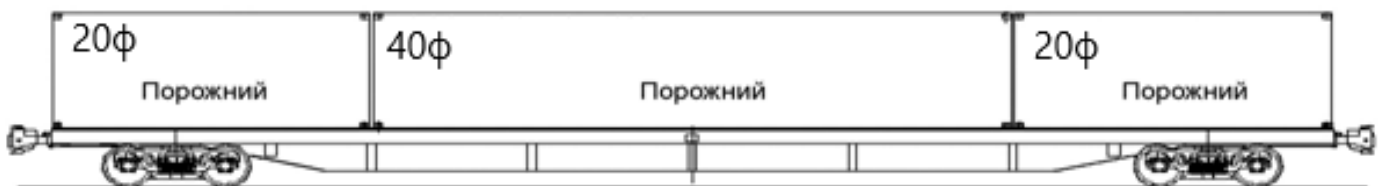
Рисунок 19 - Схема размещения на платформе двух порожних 20 футовых контейнеров и одного порожнего 40 футового контейнера
